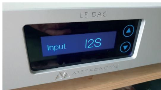
L'I<sup>2</sup>S permet d'envoyer deux canaux sur une même ligne de données. Dans les appareils audio, l'I<sup>2</sup>S est utilisé comme connexion entre deux unités, par exemple un lecteur CD ou un dispositif de streaming audio numérique et un convertisseur numérique-analogique externe.
