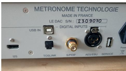
Toutes les entrées prennent en charge les signaux PCM entre 44,1 et 192 kHz ainsi que le DSD256-512. Les connectiques incluent : S/PDIF RCA 75 Ohms, AES/EBU XLR 110 Ohms, Toslink optique, USB (44,1 à 384 kHz), et le connecteur I<sup>2</sup>S HDMI, de plus en plus courant mais encore relativement peu répandu.
