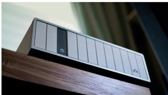
disque dur ou une clé USB. DSS 2 prend en charge les fichiers PCM jusqu'à une résolution maximale de 384 kHz et 32 bits, ainsi que les fichiers DSD jusqu'au format DSD256. En sortie, le streamer DSS 2 facilite la connexion à un convertisseur numérique/analogique grâce à des ports RCA, XLR (AES/EBU) et HDMI compatible I2S. Cependant, les Français ont choisi de ne pas inclure de sortie numérique USB.
