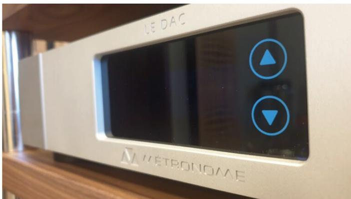
de Le DAC 2 est similaire à celle de Le Player 4, partageant un châssis en acier de 2 mm et une façade en alliage d'aluminium massif de 10 mm. Il est également équipé d'un écran de taille comparable à l'avant, accompagné de boutons tactiles intuitifs pour naviguer dans les options du menu.
